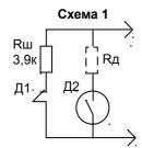
Схема №1 предназначена для подключения контактных охранных извещателей (Д1) или активных извещателей типа "Окно" (Д2) с общим током потребления не более 5 мА. Резистор Rд (1...2,2 кОм) надо выбрать в зависимости от типа извещталя (см. инструкцию на извещатель). Если необходимо подключить большое количество активных извещателей, то следует увеличить сопротивление Rш так, чтобы сопротивление зоны в нормальном состоянии было в пределах 3,5...5,0 кОм.
