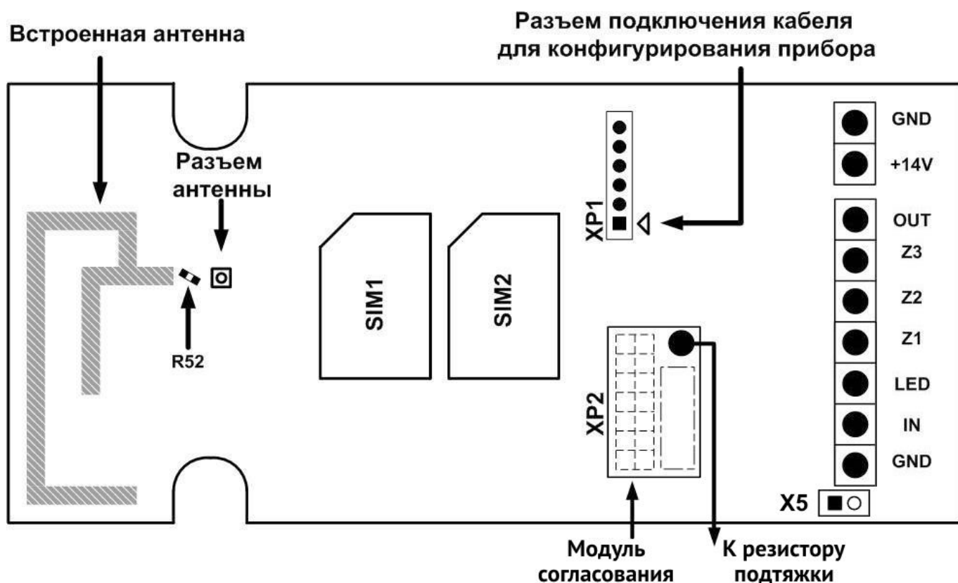
Рисунок 5. Установка модуля согласования МС-1
